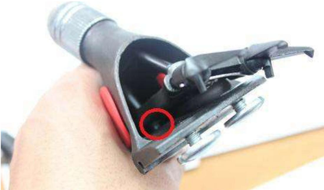
10. Первая нить резьбы центра качания на одном уровне с внутренней поверхностью корпуса; шаровое соединение свободно, сопрягаемые с ним детали убраны (обратите внимание, что рисунок предназначен только для справки. Не требуется демонтировать внутренние детали стригальной машинки, как только она была получена. Сферический штифт центра качания можно увидеть, только перевернув корпус машинки).
