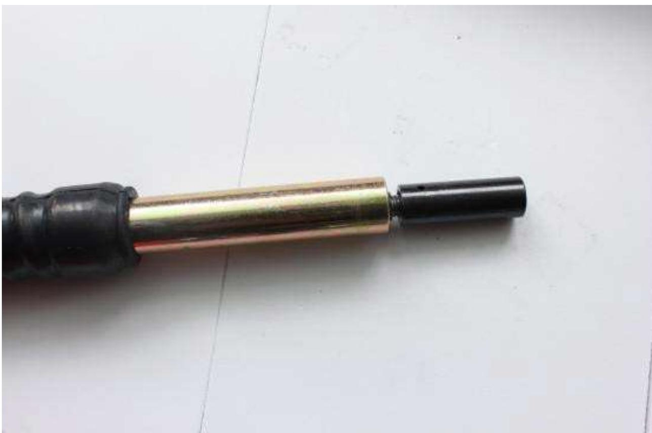
7. Отрегулируйте гибкий вал: перетащите наружу гибкую втулку на конец втулки черного адаптера, гарантируя, что втулка вытягивается на малый конец гибкого вала на 4-5 см. Затем плотно закрепите шестигранные винты на черной втулке.
