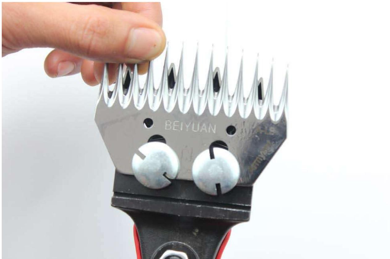
4. Правильное расстояние между вершинами зубьев ножа и гребенки должно составить 4 мм.
