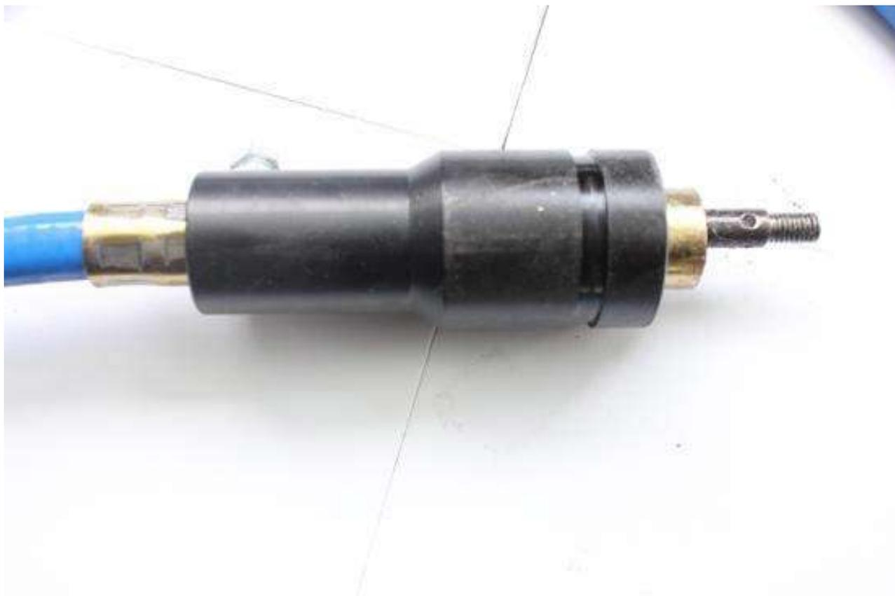
4. Закрепите винт гибкого вала на двигателе с помощью рычага и крюкового ключа (обратите внимание, что винт большего конца на гибком валу должны быть закреплен на двигателе).
