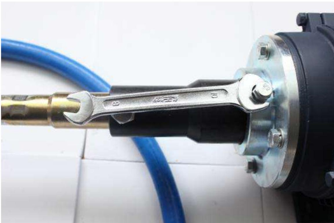
6. Закрепите втулку на гибком валу винтами (обратите внимание, что он должен быть установлен на меньшем конце вала).
