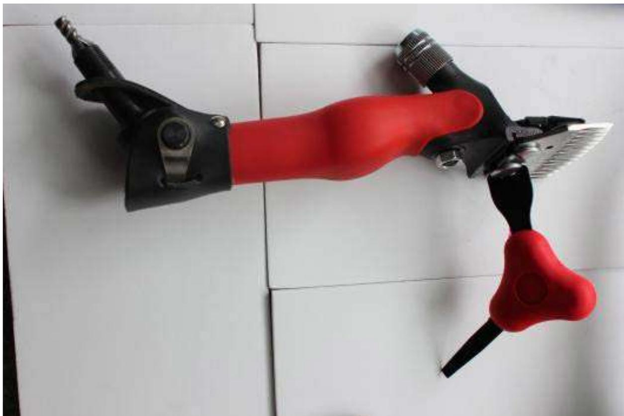
12. Правильный размер должен быть таким, чтобы расстояние между вершинами верхнего и нижнего ножа составляло 4 мм.
