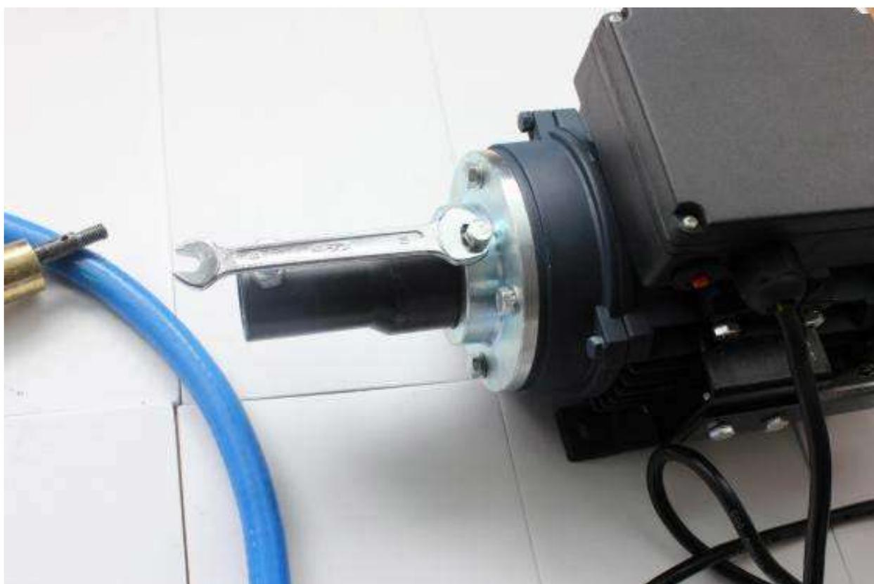
3. Установите черную переходную втулку на гибкий вал (обратите внимание, что он должен быть установлен на большем конце вала)
