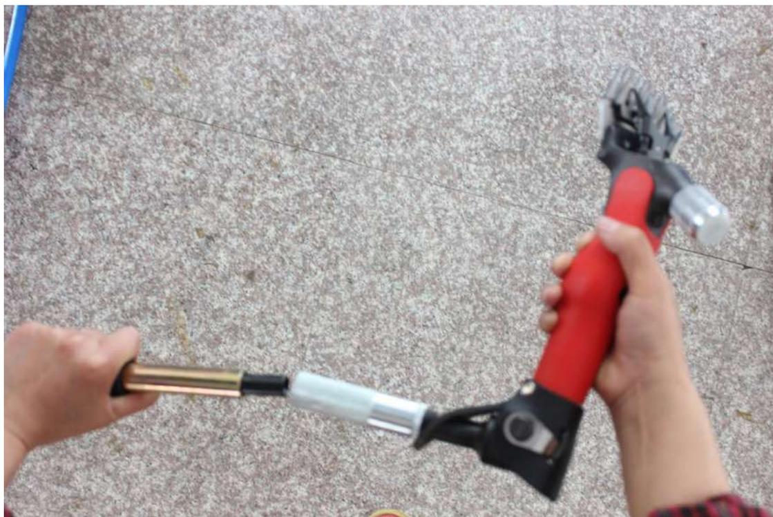
17. Прекращение работы. Требуется крепко держать машинку и сначала потянуть за шнур выключателя двигателя. После остановки работы двигателя, ослабьте обхват машинки и отложите её в сторону.
