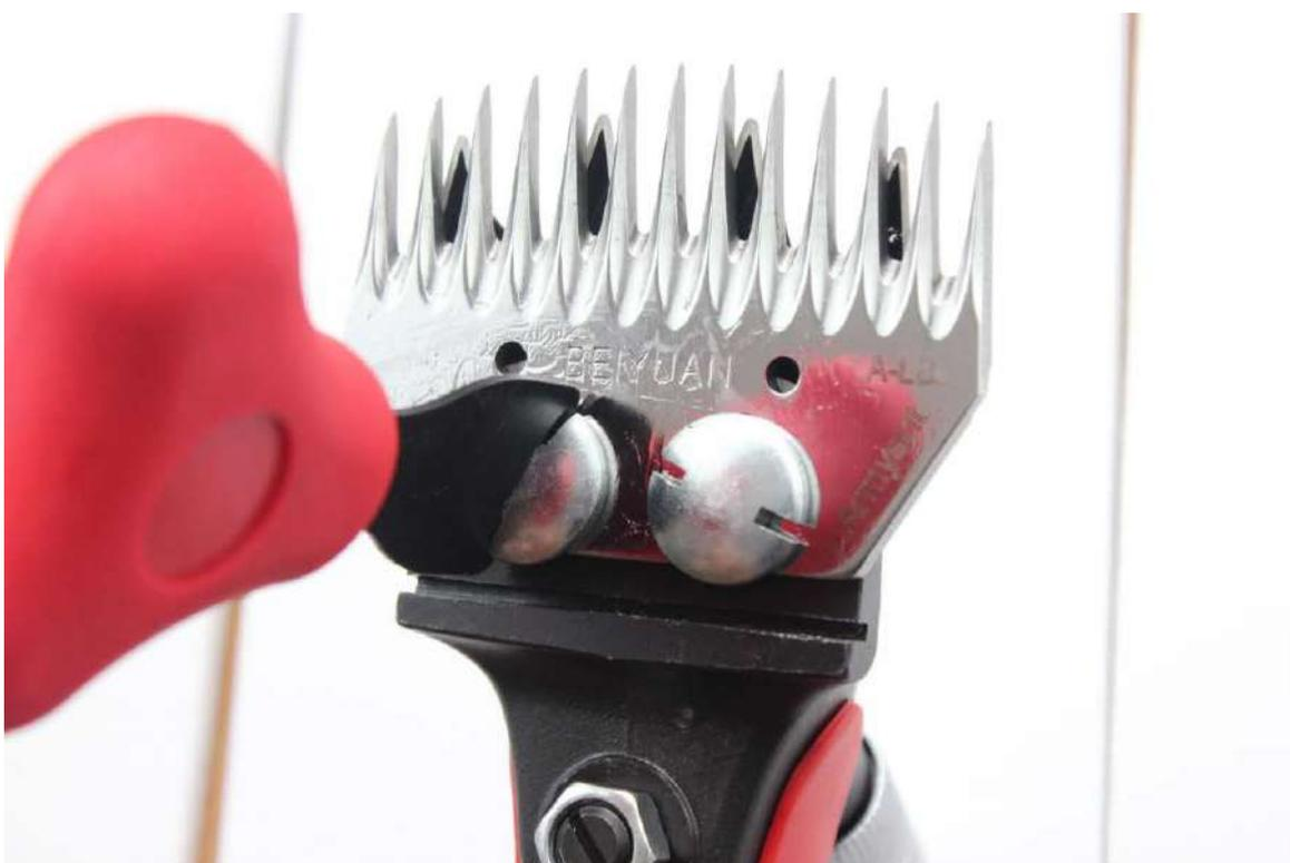
3. Вытяните гребенку так, чтобы вершины зубьев гребенки выступали на 4 мм от вершин зубьев ножа (см. рис. 4). Затем затяните винты на гребенке перед началом работы.
