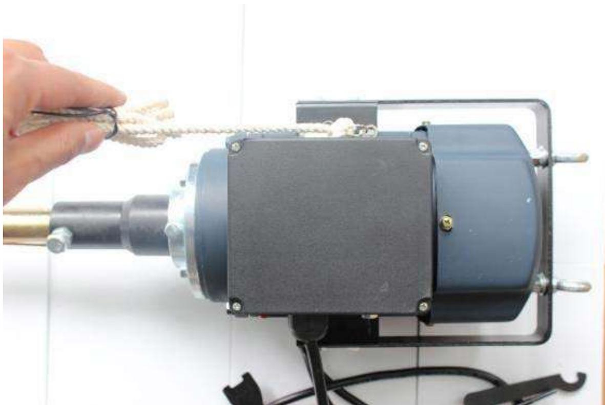
2. Отвинтите крепежные винты на черной переходной втулке с помощью гаечного ключа и выньте переходную втулку.
